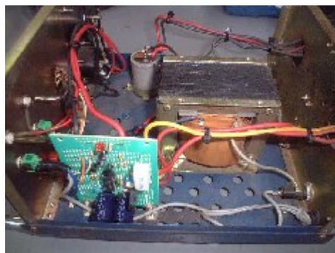
写真4 基板交換後
