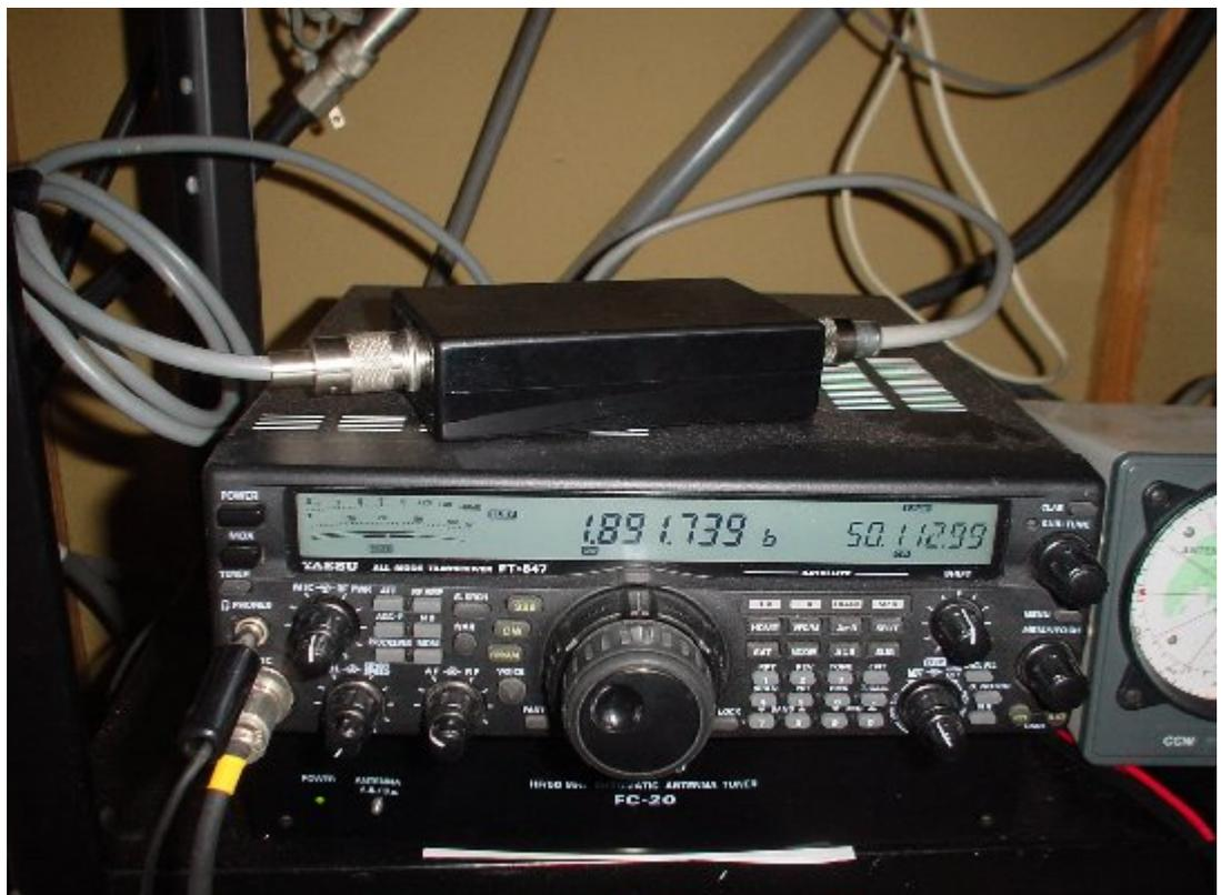
写真4 コモンモードフィルタ挿入状況
