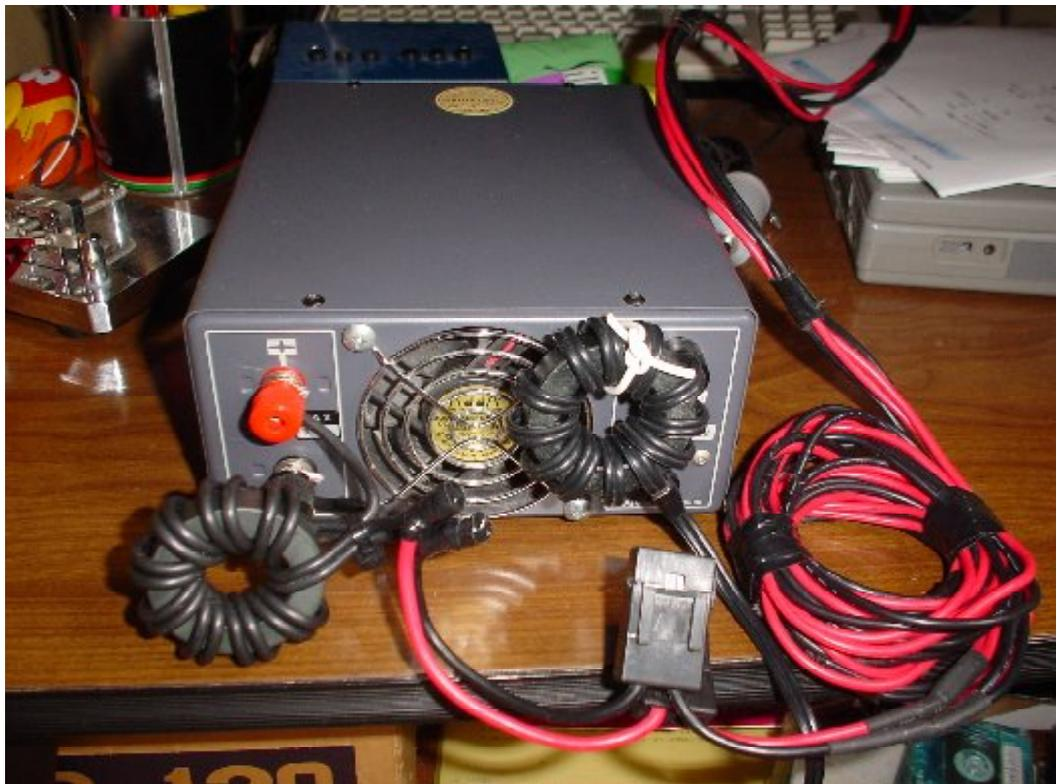
写真2 トロイダルコアによる対策
